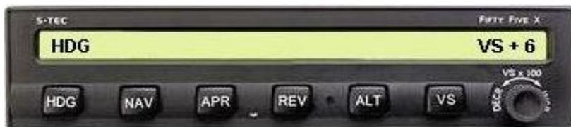
Le PA affiche et maintient la vitesse verticale de l'avion au moment de la sélection du mode VS; dès lors, le pilote peut modifier la vitesse verticale à l'aide du curseur rotatif.
